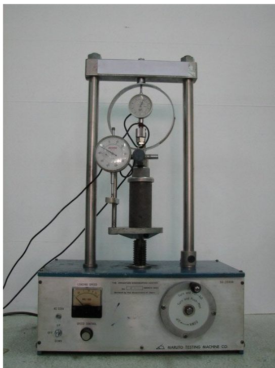
รูปที่ 4 การทดสอบแรงกดที่ระยะจมน้ำต่าง ๆ ของแท่งกดบนตัวอย่างทดสอบ
